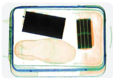
Изображение того же предмета, полученное с помощью технологии обратного рассеивания, на котором четко видны лист взрывчатки, спрятанной за сегментированной батареей ноутбука (справа) и шары из самодельной взрывчатки с детонатором, замаскированные под видом теннисных мячей.
